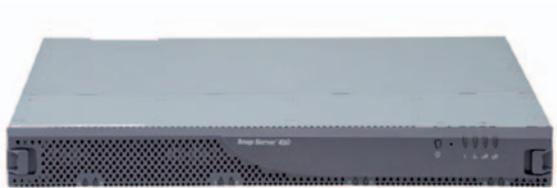
Der SnapServer 410 benötigt als Rackgerät eine Höheneinheit. Vier Plattenlaufwerke, austauschbare Hotplug, RAID 0,1,5,6,10 zeigen bereits, dass es sich dabei um ein leistungsfähiges Modell für bis zu 75 interaktiv zugreifende Benutzer handelt. Zwei Gigabit-Ethernet-Anschlüsse und verschiedene Port-Bonding-Protokolle gebündelt, erlauben einen schnellen Zugriff auf Daten oder Drucker.
